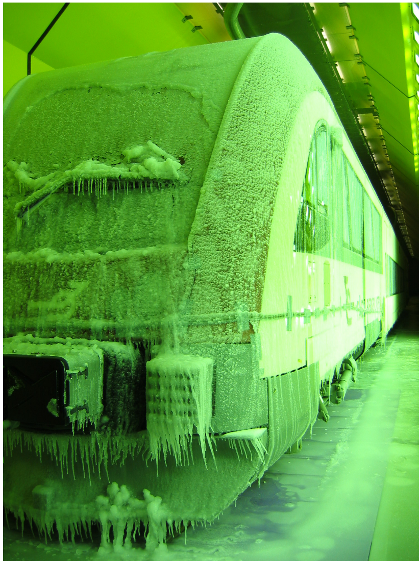
Abb. 1 Schienenfahrzeug unter extremen Klimabedingungen im Klimawindkanal (RTA)
